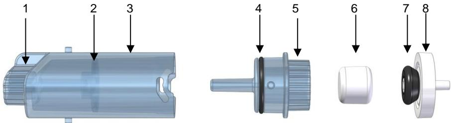
Fig. 43: Condensate trap
