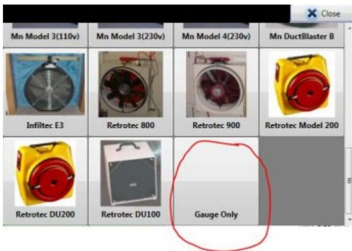
I valori di pressione sul canale A dal dispositivo "Solo manometro" sono inclusi nella pressione della stanza. I valori di pressione letti sul canale B e mostrati nella riga "Nessuna ventola" non sono inclusi nei calcoli del flusso.
