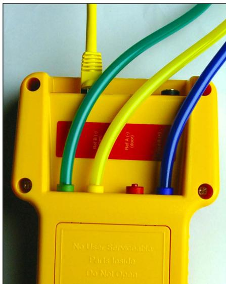
Para todas las pruebas el manómetro se quedará conectado de ésta manera.
