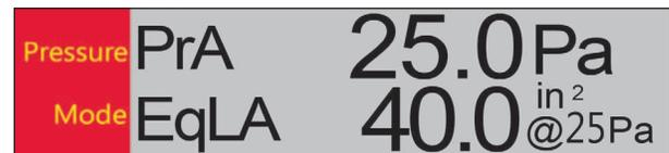
A diferencia del flujo (cfm), la "EqLA" es bastante constante sin importar si se operan diferentes presiones durante la prueba, pero generalmente se hace referencia a 10 Pa.
